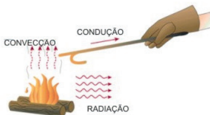
Figura 25 – Barra de ferro aquecida em uma fogueira: três processos de propagação de calor
